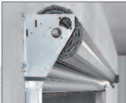
Der Rolltorpanzer ist auf der Wickelwelle vormontiert und kann problemlos in die Konsole eingebaut werden. Die platzsparende Konsole wird mit der Führungsschiene verschraubt – aufwändiges Aufmessen und Anzeichnen am Baukörper kann so entfallen.
