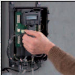
Die Steuerungen werden werkseitig steckerfertig vorbereitet.
